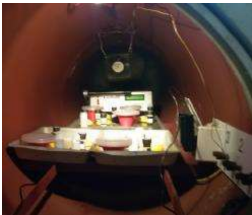
Rys.4. Wnętrze komory radonowej IFJ-600-KR z eksponowanymi detektorami pasywnymi oraz z miernikiem AlphaGUARD PQ 2000PRO.
