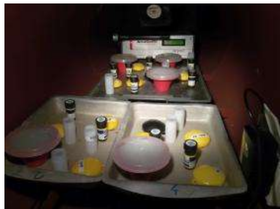
Rys.4. Wnętrze komory radonowej IFJ-600-KR z eksponowanymi detektorami pasywnymi oraz z miernikiem AlphaGUARD PQ 2000PRO.
