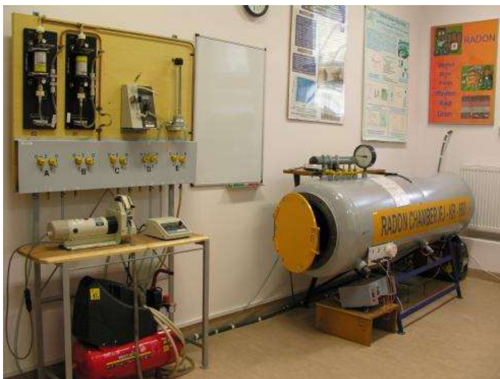
Rys.1. Stanowisko kalibracji detektorów radonu (LER IFJ PAN Kraków).
